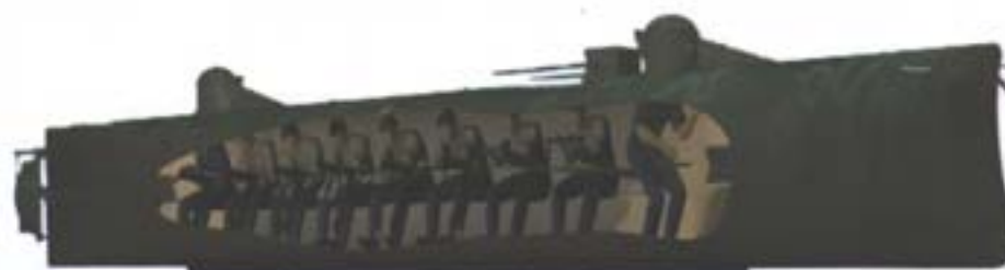
Réplica do interior do Hunley . Apesar de ter maior diâmetro do que o submarino, uma vez que foi construída como cenário para o filme The Hunley , de 1997, esta réplica mostra bem como as dimensões eram tão exíguas para uma equipa de nove homens (foto: Filipe Castro).
