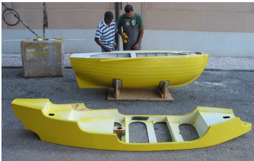
Figura 15. Preparação da união entre as duas partes do modelo
