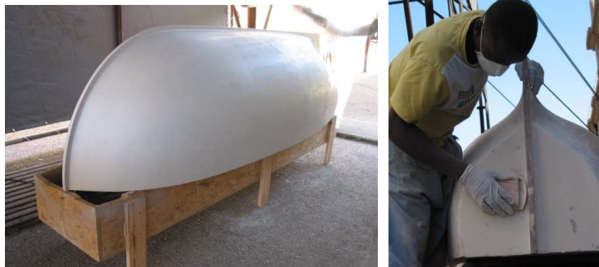
Figura 12. Modelo depois de aplicado o primário
