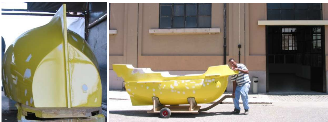
Figura 13. Depois da primeira demão de tinta acrílica e retoques de betume
