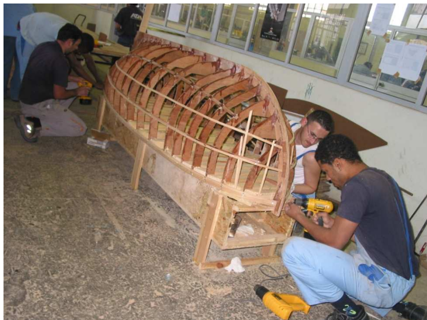
Figura 10. Esqueleto do modelo pronto
