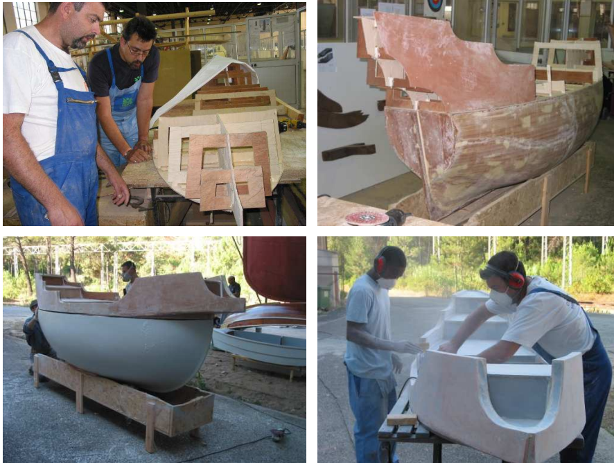
Figura 14. Construção da mareagem e castelos
