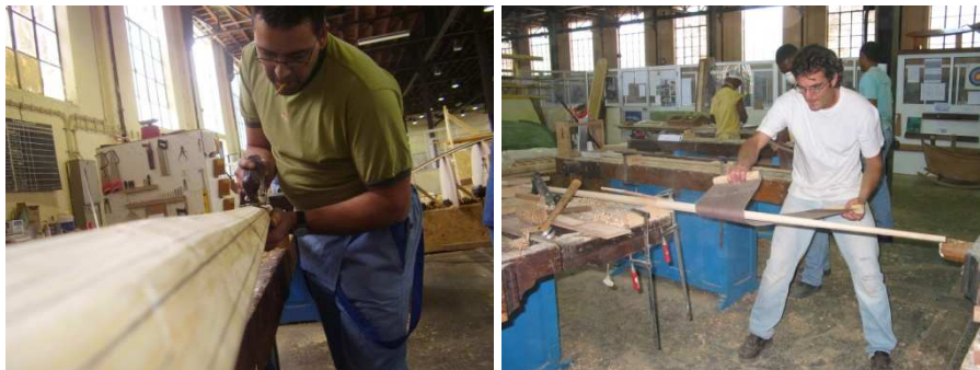
Figura 17. Trabalho de redução da secção quadrada a redonda para os mastros e vergas
